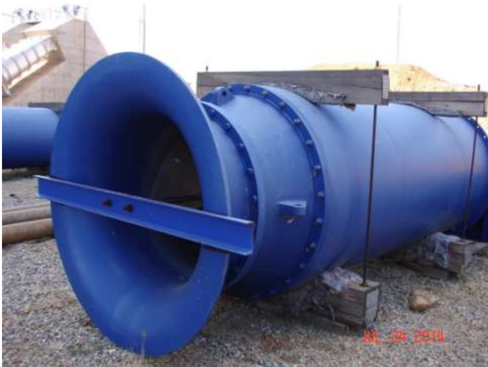
Projeto Salitre – Bombas a serem instaladas: capacidade 7 m 3 /seg (1.500 CV)
